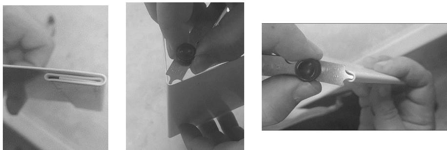
Figure 10 - 后成型的弯曲试验- 挤压和测量
