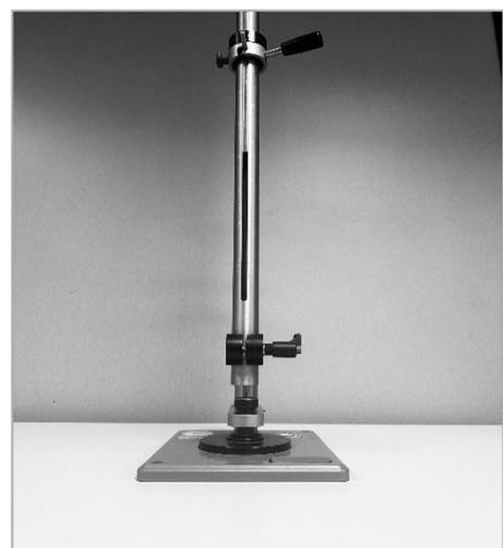
Figure 11 – 冲击试验
